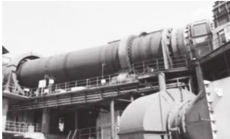
Hình 1.2. Lò nung để sản xuất graphit từ than cốc [61].
