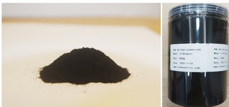
Hình 2.1. Graphen oxit được sử dụng trong nghiên cứu này.
