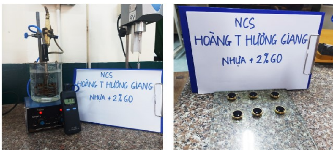
Hình 2.14. Thiết bị đo và mẫu thí nghiệm điểm hóa mềm.
