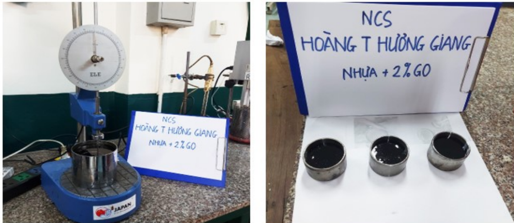
Hình 2.10. Thiết bị đo và mẫu thí nghiệm độ kim lún.
