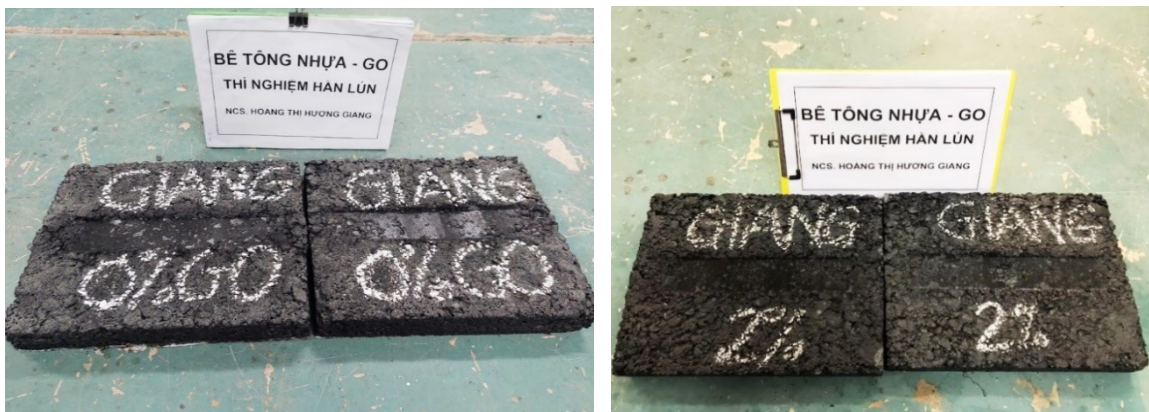
Hình 3.10. Mẫu BTN_60/70 và BTN_GO sau khi chạy LVBX.
