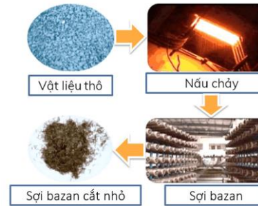
Hình 1.2. Quy trình sản xuất sợi bazan.
