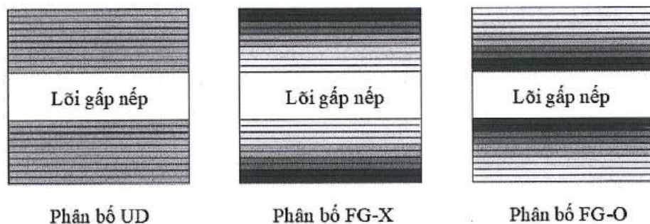
Hình 2.4. Các dạng phân bố graphene trong các lớp mặt của vỏ trụ và vỏ tròn FG-GRC sandwich lõi gấp nếp
