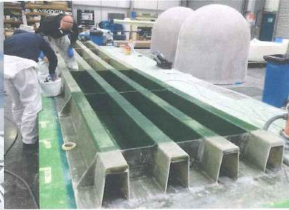
d) Cầu đi bộ làm từ vật liệu composite (làng Sedlescombe, quận Rother, Anh)
